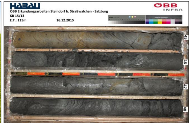
Bohrkerne im Flyschgestein
